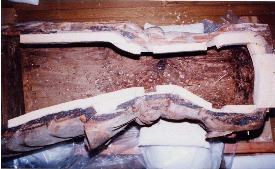
欠損部補強材の接着にアルタインMを用いる
